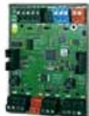
Relié à un automate TILLYS, le module déporté MD-EQUILOCK permet l'acquisition et le transport sur un bus sécurisé et auto-alimenté, des informations de contact et d'autoprotection de capteurs intrusion (radars, contacts d'ouverture, ...) équipés de transpondeur EQUILOCK. Les transpondeurs EQUILOCK (moins d'1 cm3), s'intègrent dans les capteurs en lieu et place des résistances d'équilibrage.
