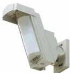
Détecteur double technologie anti-masque. La double détection infrarouge combinée à l'hyperfréquence permet au HX une grande finesse de détection. La détection digitale par microprocesseur analyse luminosité, température ambiante et oscillation végétale ce qui rend le produit stable fiable et précis.
