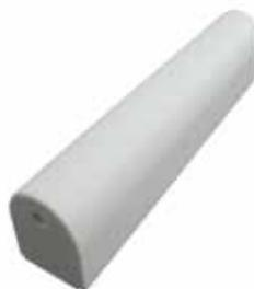
Le TAG se colle sur toutes ouvertures (portes, fenêtres, volets, baies coulissantes...) et objets mobiliers par adhésif double face industriel à très forte résistance à l'arrachement. Détecte les chocs et les vibrations typiques d'une tentative d'effraction et transmet l'alerte avant intrusion. Niveau de sensibilité réglable de 1 à 9 depuis la centrale.
